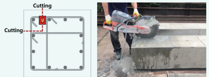
(b) 기둥 단면 커팅후 RCC 묻힘 상태 확인
